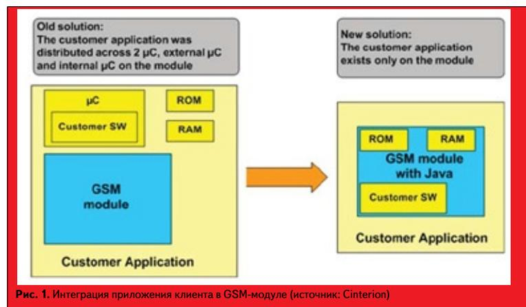
Рис. 1. Интеграция приложения клиента в GSM-модуле (источник: Cinterion)
