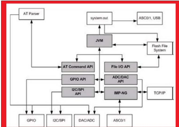
Рис. 4. Обзор API и аппаратных интерфейсов
