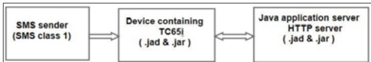
Рис. 9. Блок-схема OTA
